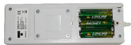
Foto 68 – 1-Schroef met kruisgleuf, 2-Batterijklep, 3-Drukpunt om de batterijklep te ontgrendelen
